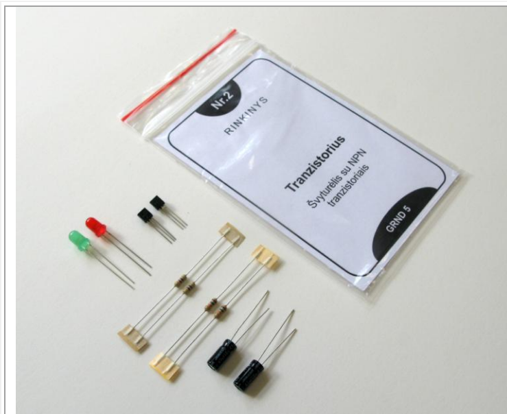
1.7 pav. Elektronikos elementų rinkinys. Švyturėlis su NPN tranzistoriais. Grandinė Nr.5
